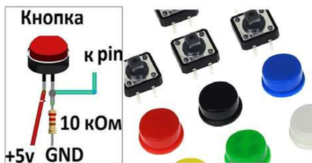
Рис. 1. Схема подключения тактовой кнопки к микроконтроллерной плате
